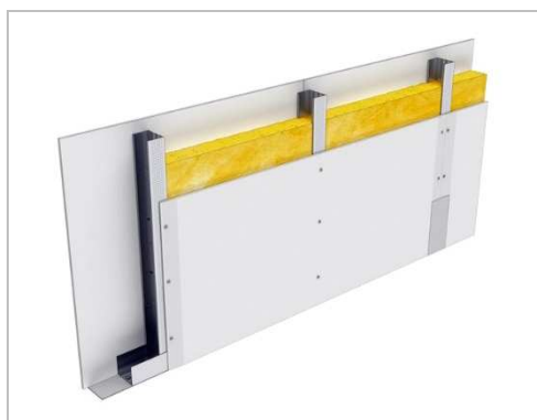
Rysunek 4.6 Pojedyncza konstrukcja z dwustronnym, jednowarstwowym poszyciem płytami
