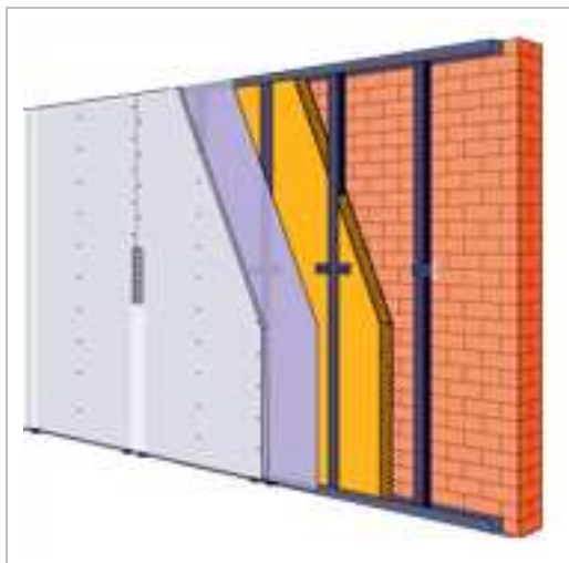
Rysunek 4.4 Okładzina ścienna na profilach CD 60 i wieszakach ES
