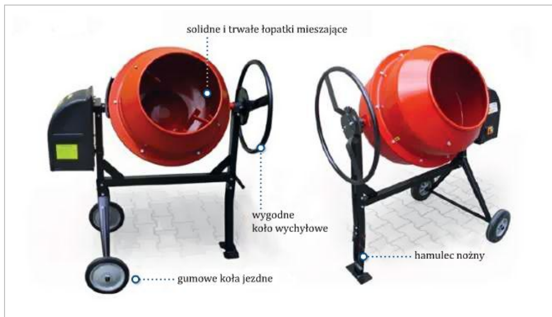
Rysunek 7.11 Betoniarki wolnospadowe
