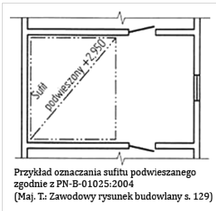
Rysunek 2.11 Przykład oznaczania sufitu podwieszanego
