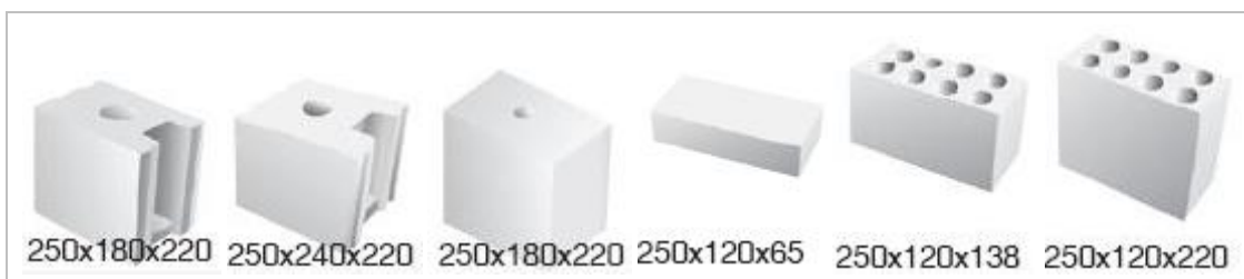
Rysunek 1.5 Pełne silikatowe elementy murowe, odpowiednio: NP18, NP24, Silikat A, Silikat T1 NF, Silikat T2 NFD, Silikat T3 NFD
