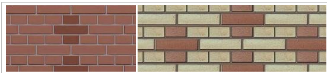
Rysunek 2.6 Układ cegieł w murze w wiązaniu krzyżykowym (weneckim)
