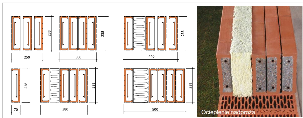
Rysunek 3.6 Nadproże ceramiczno-żelbetowe w układzie pionowym
