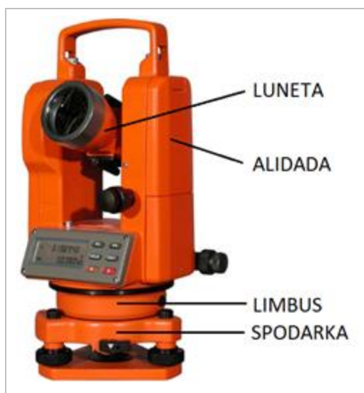
Rysunek 7.5 Teodolit elektroniczny
