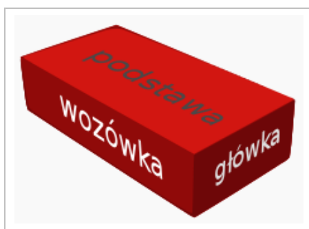
Rysunek 8.7 Nazewnictwo poszczególnych powierzchni cegły
